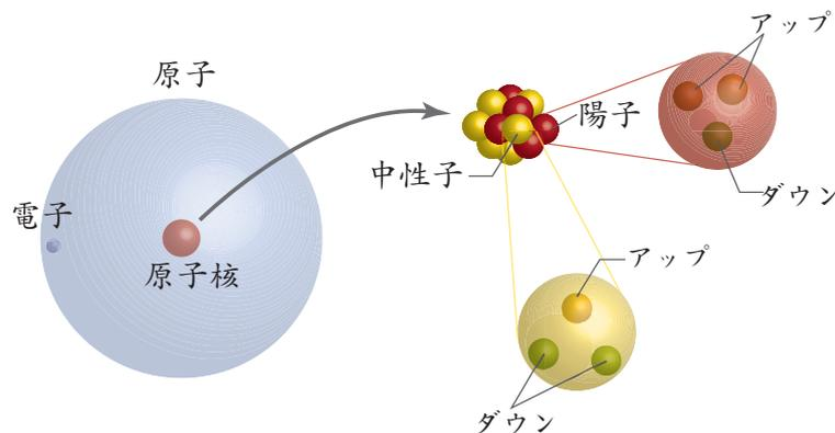
図1 原子の構造：原子は原子核と電子から構成されており、原子核はさらに中性子と陽子から構成されている。電子は素粒子であり、(現在の標準理論では)それ以上分割することのできない基本粒子と考えられているが、陽子と中性子は素粒子ではなく、それぞれアップ、ダウンと呼ばれるクォークという素粒子から構成されていると考えられている。電子はレプトンと呼ばれる素粒子の1種類であると考えられている。
